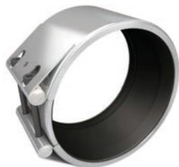
Le raccord autorise une jonction sûre et durable de tous les types de conduites en PEHD, PVC, fonte ductile, fonte grise, acier noir, acier inoxydable, fibrociment, béton et PRV sans reprise des charges axiales pour une pression de service jusqu'à 25 bar.
